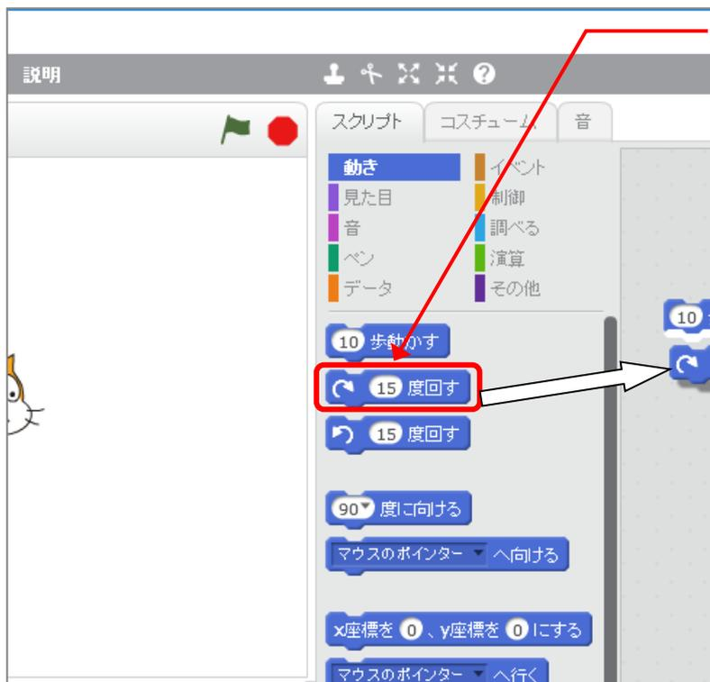
2 「15 度回す」ブロックをスクリプトエリアの「10 歩動かす」ブロックの下までドラッグします。
